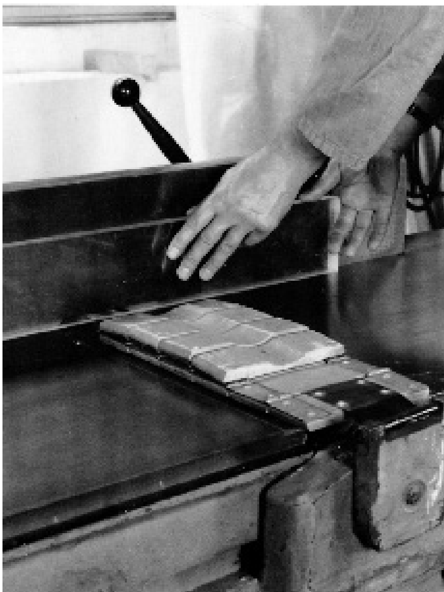
Abb. 36: Glätten der Kanten mit Abrichthobel
