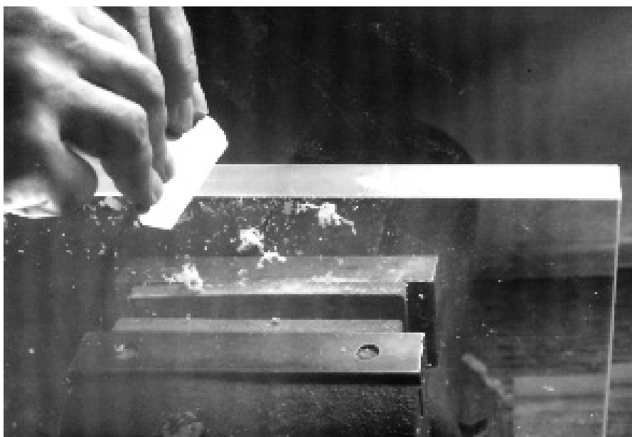
Abb. 35: Abziehen von PLEXIGLAS® mit Ziehklinge
